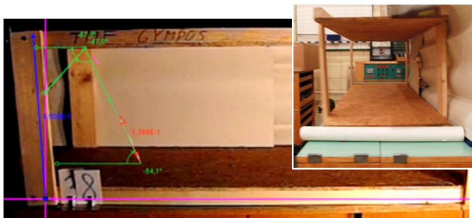
Obr. 6: Experimentálna aparátúra dvoch drevených paralelných platní
