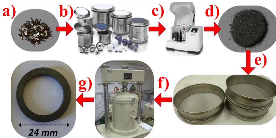
Obr. 1 Štandardný proces pri laboratórnej príprave magneticky mäkkých vzoriek za pomoci metód práškovej metalurgie a) úlomky zliatiny b) mlecie nádoby s mlecími guľami c) planetárny guľový mlyn d) feromagnetický prášok e) jemné sitá f) vysokotlakový hydraulický lis g) finálny produkt - kompaktovaná vzorka
