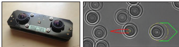
Obr. 2. Leap Motion. a) Rozložený senzor. b) Obráz optickej pinzety – červenou (uzavretá) a zelenou (otvorená) sú pinzety ovládané pomocou Leap Motion.
