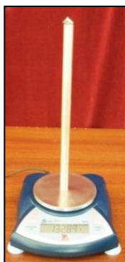
Obr. 1. Usporiadanie interaktívnej demonštrácie, Lenivý magnet: digitálne váhy, kovová rúrka, neodýmový magnet.
